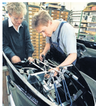
1995 ist Karola Bräuer Chefin der neugegründeten DSG und checkt mit Lutz Riethig den Steuermechanismus eines Viererbobs für die Engländer.
